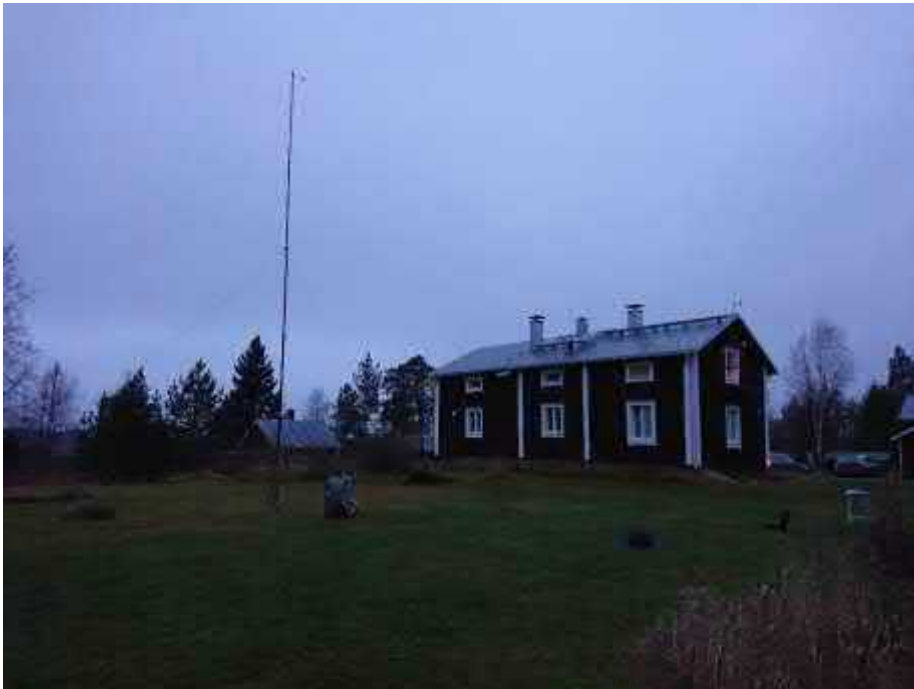
Kuva 2. Näkymä mitauspaikalta 1 asuinrakennuksen suuntaan. Alhaalla oikealla mittausmikrofonin kupomainen tuulisuoja ja keskellä vasemmalla säähavaintomasto.
